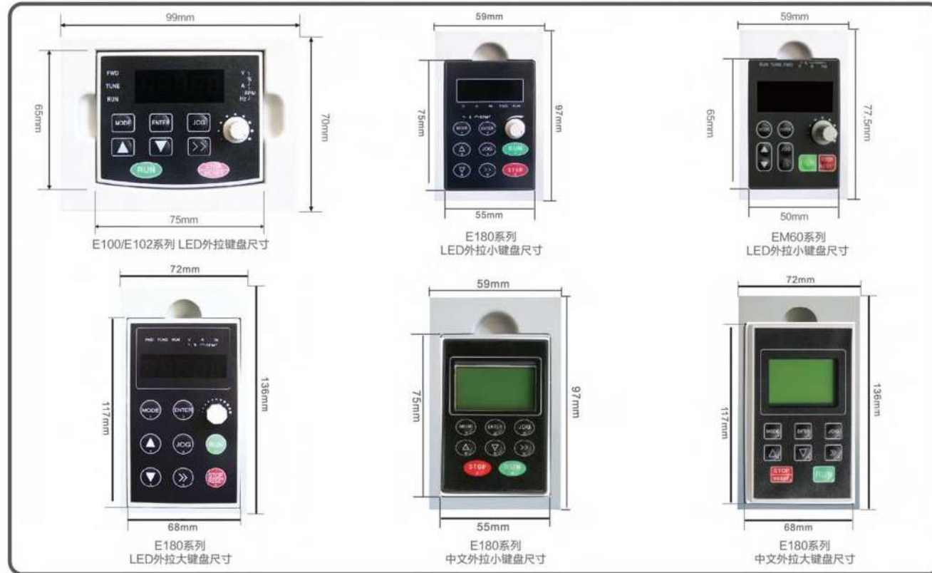
E系列外引键盘尺寸及开孔尺寸
